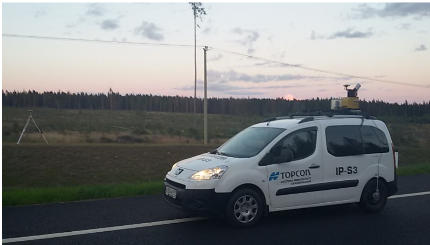
Система мобильного сканирования Торсон IP-S3
